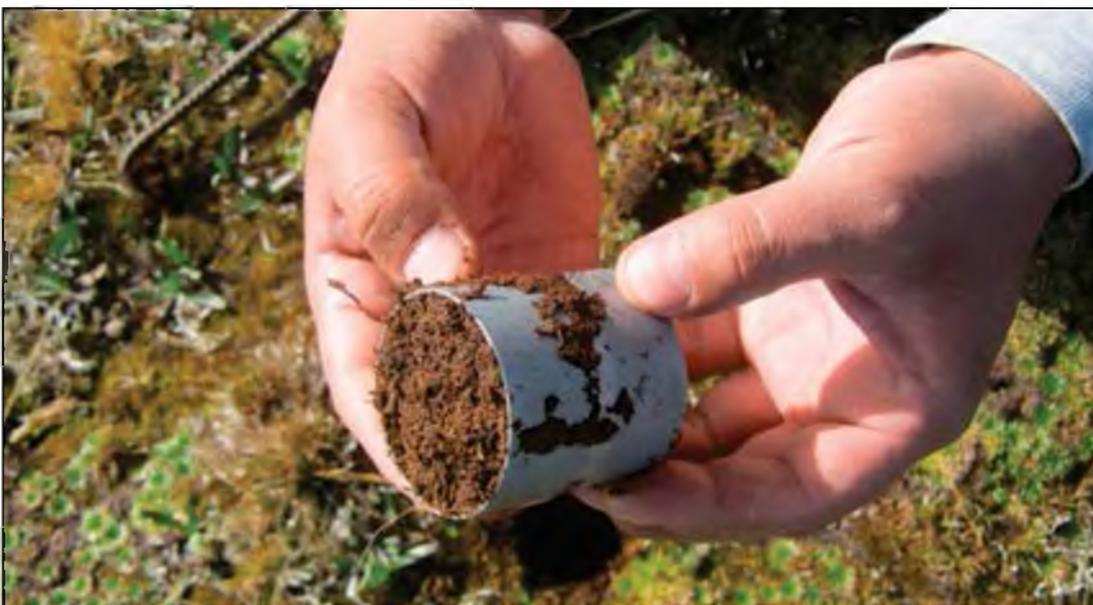
Figura N° 3: Muestreo de suelo con cilindro de aluminio.
