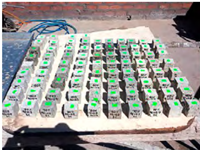
Figura 3. Morteros de cartón para el análisis de esfuerzo a compresión
