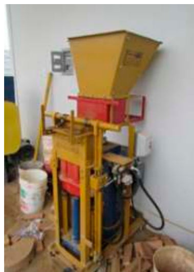
Máquina de operación manual para la elaboración de bloques de tierra comprimida
