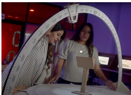
Figura 2. Heliodón de piezas desmontables
