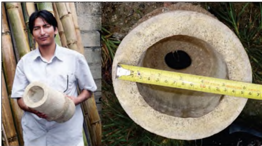
Figura N° 4: Muestra de Guadua angustifolia , que alcanza una sección basal de 16 cm de diámetro.
