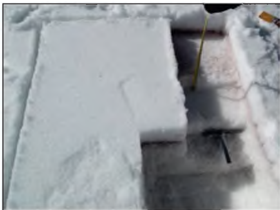
Figura N° 2: Perforaciones para determinar el volumen de masa acumulada.
