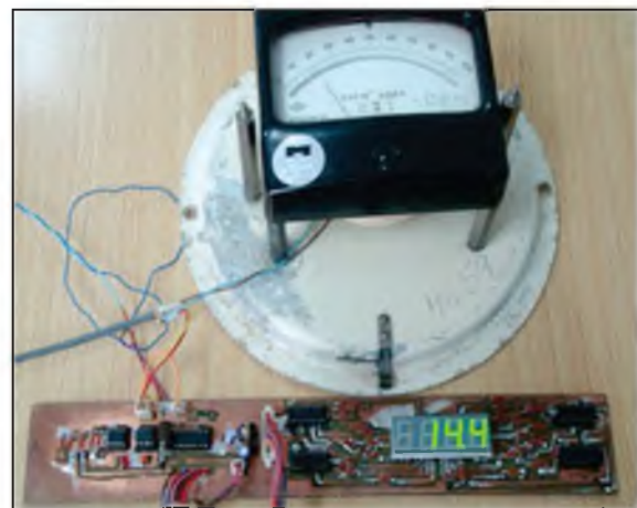
Figura N° 5: Prototipo del galvanómetro digital frente al galvanómetro analógico durante una medición de prueba.
