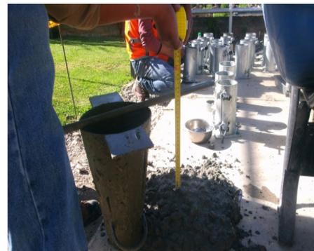
**Figura 11.** Asentamiento del concreto de 7 ¾»
