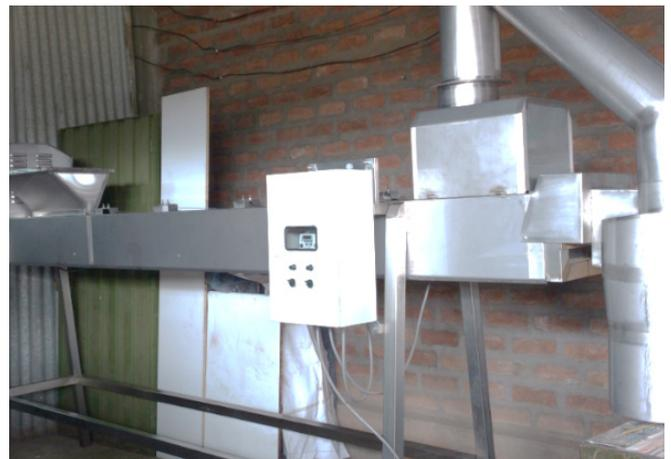
**Figura 6.** Máquina cortadora de ají jalapeño.
