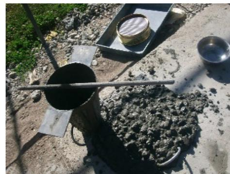
**Figura 12.** Asentamiento del concreto de 9 ½»
