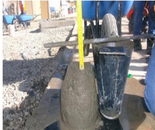
**Figura 10.** Asentamiento del concreto de 5 ½»
