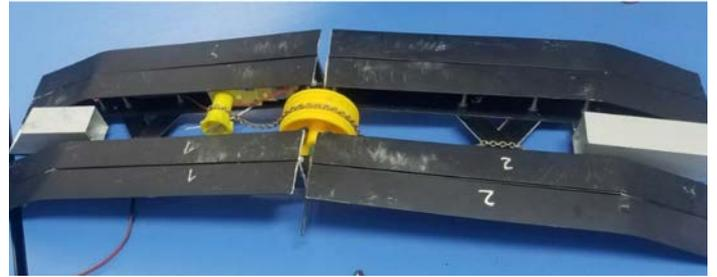
Figura 6. Puente desplegado y desacoplado del carro
