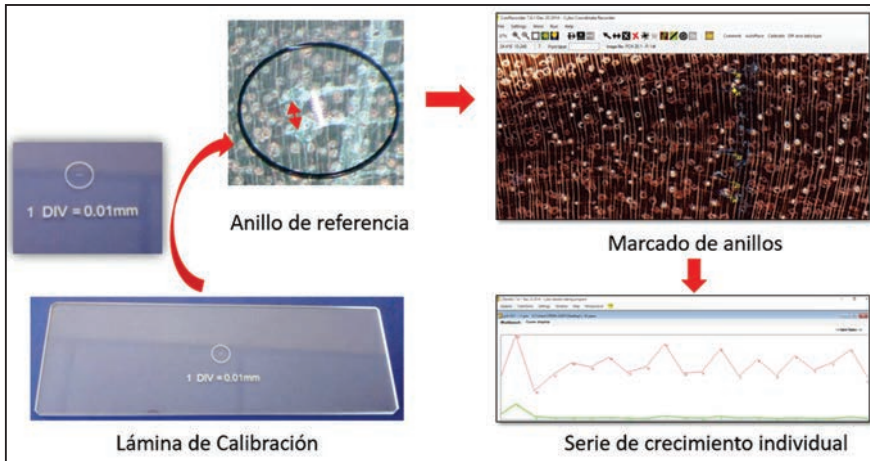
Figura 3. Medición de anillos de crecimiento (coorecorder).
